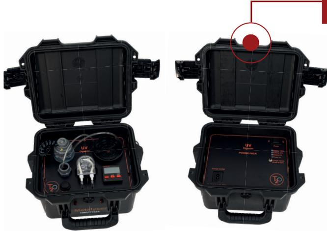
Un système de digestion aux UV, couplant un puissant système de recirculation à double longueur d'onde avec un pack de batteries haute capacité, permettant la digestion des échantillons portable pour fournir une solution complète d'analyse de métaux lourds sur le terrain.
